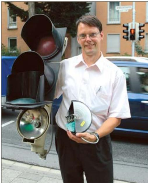
AUSGEDIENT. Die gute alte 40-Watt-Glühbirne, die derzeit noch in fast allen Ampelanlagen in Darmstadt eingesetzt ist, wird ab sofort nach und nach durch neuartige LED-Technik ersetzt und getestet. Unser rh-Bild zeigt Stefan Hartmann, Dipl.-Ing. des Straßenverkehrsamtes Darmstadt, mit einer herkömmlich bestückten Ampel und einem neuartigen LED-Signalgeber, der mit 20 Leuchtdioden bestückt ist. (Zum Bericht) (Bild/Text: rh)
