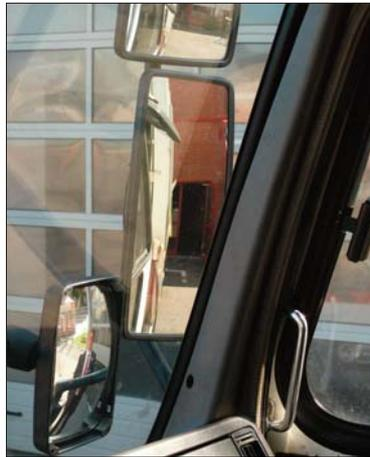
UBERBLICK. Im Vorrgriff auf zu erwartende EU-Regelungen wurden Anfang September die Großfahrzeuge des EAD mit einem sogenannten „Dobli-Spiegel“ ausgerüstet. Dieser gewährt dem Fahrer Einblick in den Toten Winkel. (Zum Bericht) (Bild: dos)
