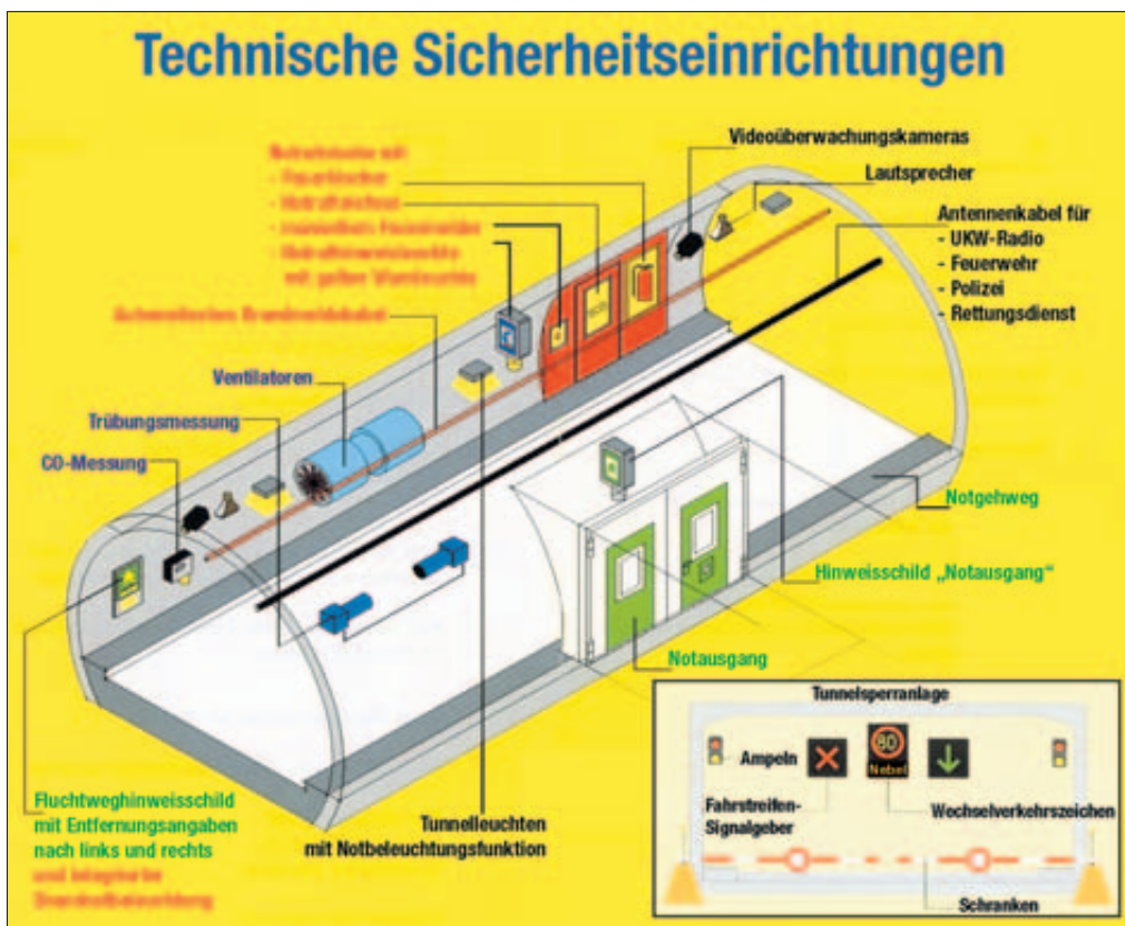
DIE UMFANGREICHE betriebstechnische Tunnelausrüstung im Querschnitt.
