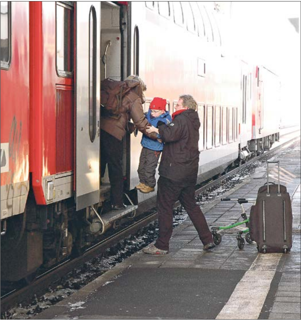
76 ZENTIMETER müssen beim Einstieg in den Zug am Eberstädter Bahnhof überwunden werden – ein Hindernis nicht nur für Rollstuhlfahrer. Ab 2017 soll das ein Ende haben. (Zum Bericht) (Archivbild: Ralf Hellriegel)
