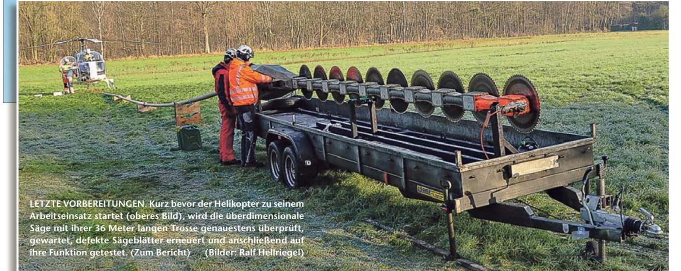
**LETZTE VORBEREITUNGEN.** Kurz bevor der Helikopter zu seinem Arbeitseinsatz startet (oberes Bild), wird die überdimensionale Säge mit ihrer 36 Meter langen Trosse genauestens überprüft, gewartet, defekte Sägeblätter erneuert und anschließend auf ihre Funktion getestet. (Zum Bericht) (Bilder: Ralf Hellriegel)
